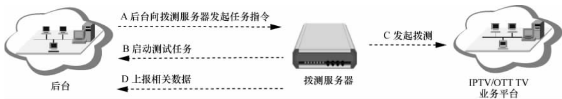
图 10 针对流媒体业务的策略拨测原理
