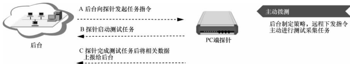
图5 用户侧PC探针主动拨测原理
