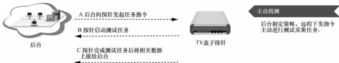
图 8 用户侧 TV 探针主动拨测原理
