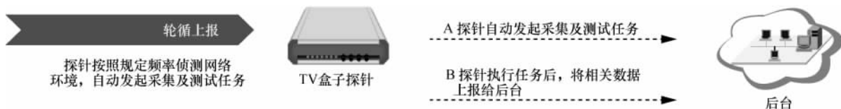
图 9 TV 探针主动循环上报原理
