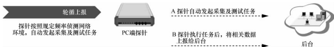
图6 PC探针主动循环上报原理
